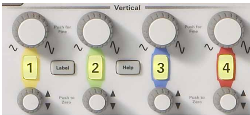
Figura 5 Controlli verticali (asse Y) dell'oscilloscopio
