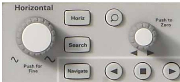
Figura 4 Controlli orizzontali (asse X) dell'oscilloscopio
