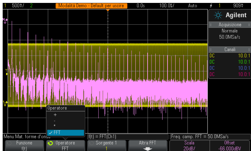
Figura 43 Eseguire una funzione matematica FFT su un clock digitale ripetitivo
