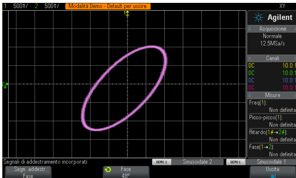
Figura 40 Modello di Lissajous che utilizza una modalità XY dell'oscilloscopio di due onde sinusoidali della stessa frequenza, ma reciprocamente fuori fase di 48 gradi
